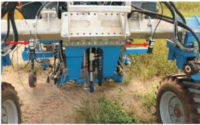
Rys. 5. Kamery zamontowane na konstrukcji robota Fig. 5. Cameras mounted on the robot's design
