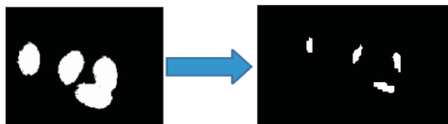
Rys. 2. W wyniku działania funkcji „imerode (,erozji”) obraz leżących blisko siebie ziaren został rozdzielony Fig. As a result of the „imerode” function, the image of the grains which lie close to each other has been separated
