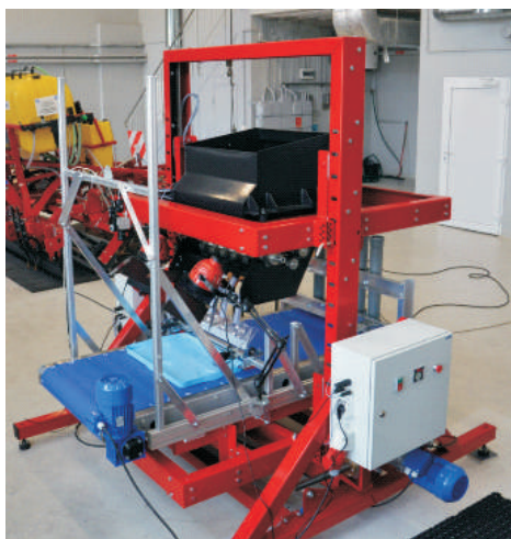
Rys. 1. Stanowisko do badania jakości wysiewu Fig. 1. Test station for seeding quality
