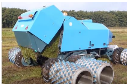
Rys. 6. Samojedna prasa z mieszanym zestawem podwójnych kół podczas wyładunku beli [17]
