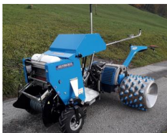
Rys. 7. Samojedna prasa do małych bel cylindrycznych z napędem na dwa pojedyncze koła z ostrogami [18]
