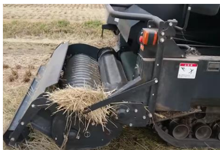
Rys. 9. Zespół podbierająco-podający samojezdnej prasy zwijającej SR1020 [22]
