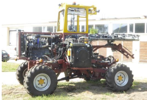
Rys. 4. Model badawczy automatycznego robota do zakładania upraw leśnych oraz zalesiania terenów rekultywowanych i porolnych [źródło: opracowanie własne]
