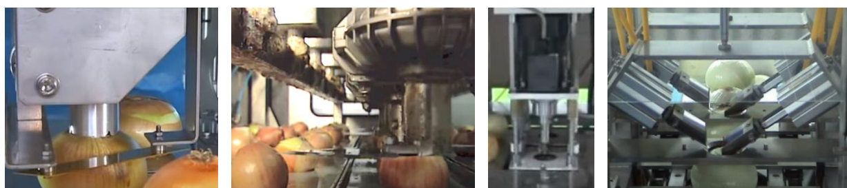
Rys. 4. Proces nacinania cebuli w płaszczyźnie poziomej (fot. od lewej firmy Sevenchefs, Finis., CP100, IOPACK)
