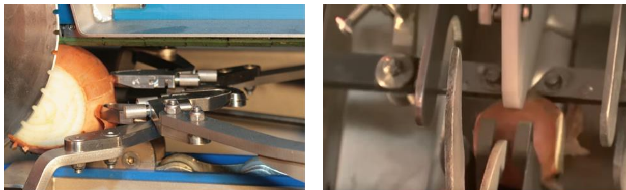
Rys. 3. Układ nacinania suchej łuski w technologii poziomej ( fot. od lewej firmy Sormac, Dofra)
