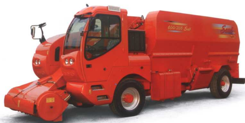
Rys. 4. Samojezdny wóz paszowy SAM 5 firmy Seko z urządzeniem do samozaładunku umieszczonym między kabiną operatora a silnikiem Fig. 4. Self-propelled forage trailer SAM 5 of the firm Seko equipped with selfloading device located between driver's cab and the engine
