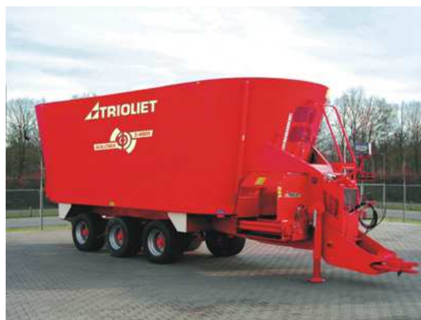
Rys. 8. Przyczepiany wóz paszowy firmy Triolet o pojemności zbiornika 46 m 3 na układzie osi tridem
