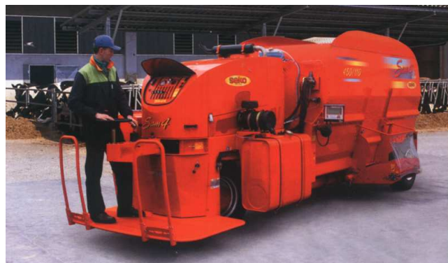
Rys. 6. Samojezdny wóz paszowy SAM 4 SELF 450/110 firmy Seko o pojemności zbiornika 11 m 3 bez urządzenia samozaładoczego Fig. 6. Self-propelled forage trailer SAM 4 SELF 450/110 of the firm Seko with the tank of 11 m 3 capacity without selfloading device
