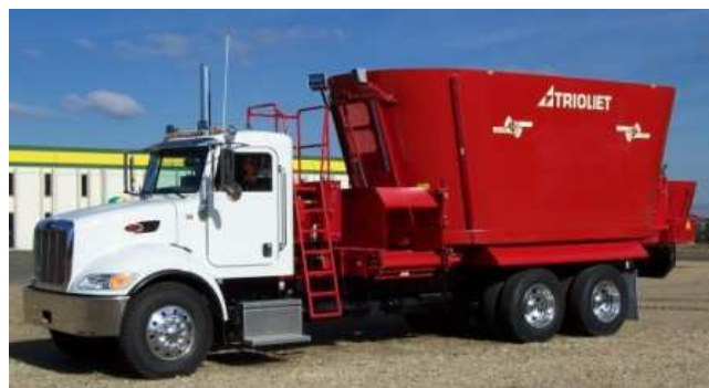
Rys. 5. Zbiornik do przygotowania pasz firmy Triolet model WLK nabudowany na podwoziu samochodu ciężarowego Fig. 5. The tank for forage preparation of the firm Triolet, WLK model, mounted on the lorry chassis
