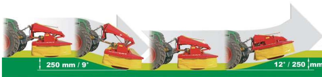
Rys. 2. Pionowe wychylenia ramy kozła wywoływane ruchami kopiącej teren kosiarki czołowej
