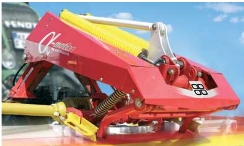
Rys. 1. Ogólny widok nowego kozła zawieszenia firmy Pöttinger dla ciągnikowych kosiarek czołowych
