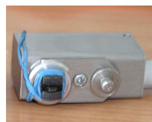
Rys. 5. a) Urządzenie pomiarowe \mu SCAN 500, b) sonda pomiarowa urządzenia \mu SCAN 500
