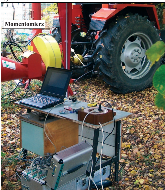
Rys. 1. Rozdrabniacz (rębarka) do drewna zagregowana z ciągnikiem URSUS 4512 a) pozycja robocza, b) z zamontowanym momentomierzem i stanowiskiem pomiarowym w miejscu badań
