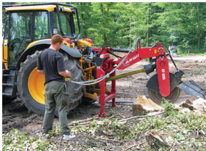
Rys. 5. Frez do pniaków AHWISF 900
