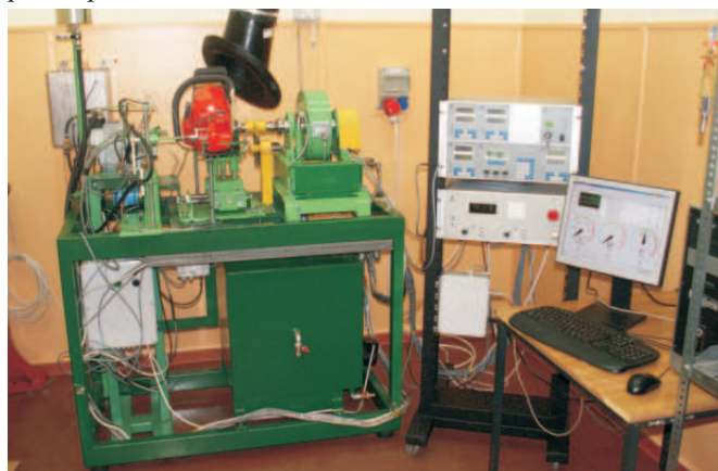
Rys. 1. Hamownia małych silników spalinowych Fig. 1. Test house for small combustion engines
