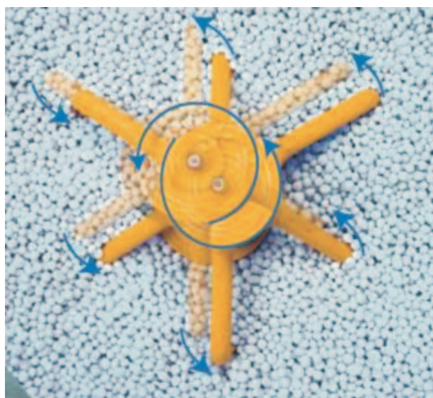
Rys. 5. Mieszadło w rozsiwaczu firmy Bogballe Fig. 5. Mixer used in Bogballe fertilizer distributor
