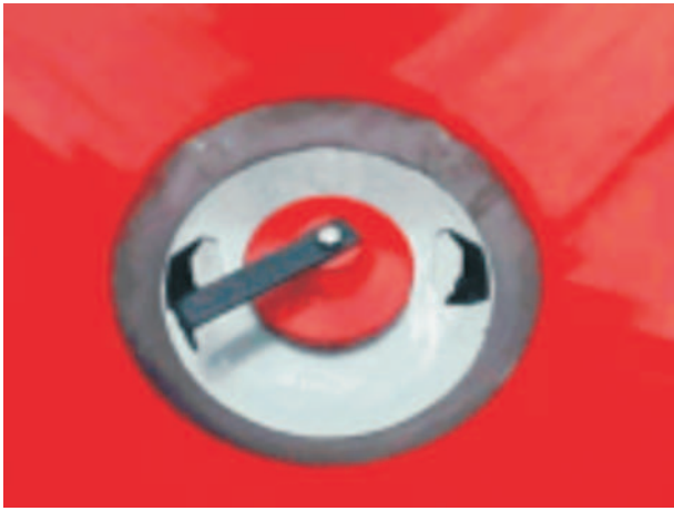
Rys. 6. Mieszadło w rozsiewaczu firmy Kuhn Fig. 6. Mixer used in Kuhn fertilizer distributor
