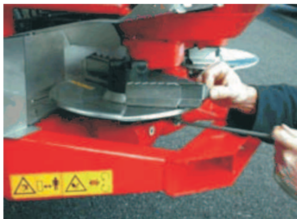
Rys. 4. Zmiana długości łopatek na tarczy rozsiwającej w rozsiwaczu firmy Rauch Fig. 4. Change of length of distributor disc blades used in Rauch fertilizer distributor
