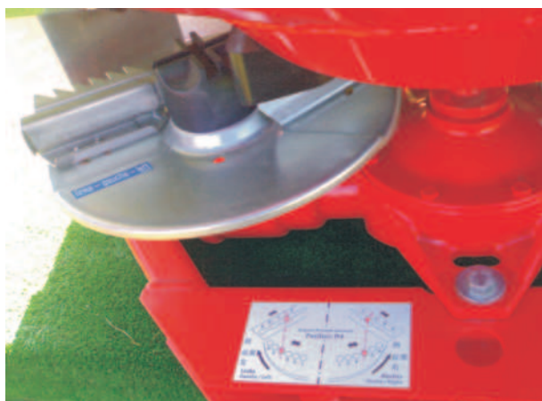
Rys. 2. Uzębione łopatki na tarczy rozsiwającej w rozsiwaczu firmy Kuhn Fig. 2. Toothed blades of distributor disc used in Kuhn fertilizer distributor
