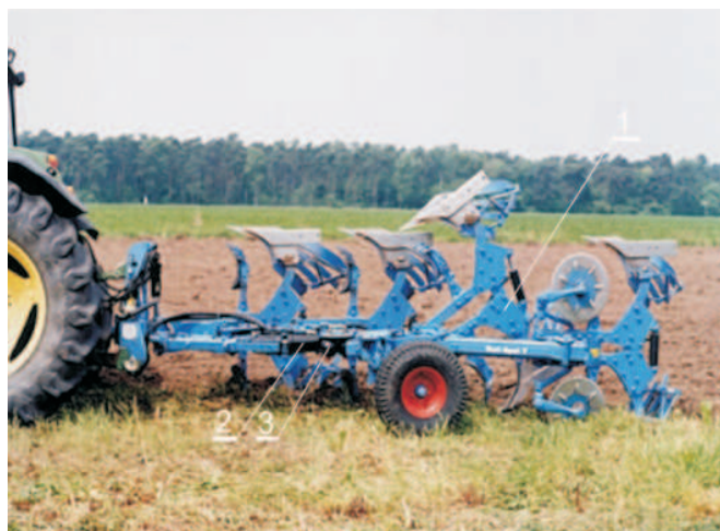
Rys. 8. Widok pługa obracalnego „Vari Opal 9” z hydraulicznym zabezpieczeniem przeciążeniowym w czasie pracy, prod. Lemken GmbH&Co. KG: 1 - korpus płużny, 2- siłownik, 3- akumulator hydrauliczno-gazowy
