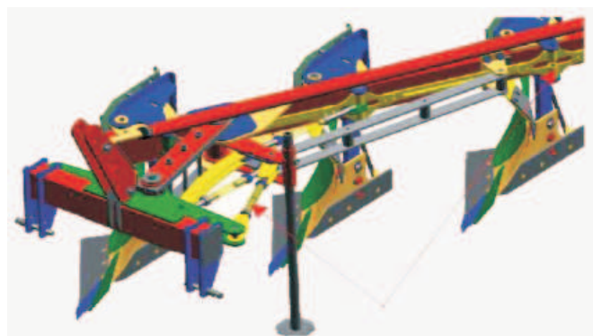
Rys. 3. Układ płynnej regulacji szerokości roboczej (30-44 cm) i ustawienia korpusów płuznych w pługu U-183/1, prod. PP-U-H „AKPIL” Pilzno
