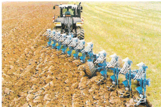
Rys. 5. Widok pracy pług VariTitan wyposażonego w wyżej przedstawioną regulację, prod. Lemken GmbH&Co. KG
