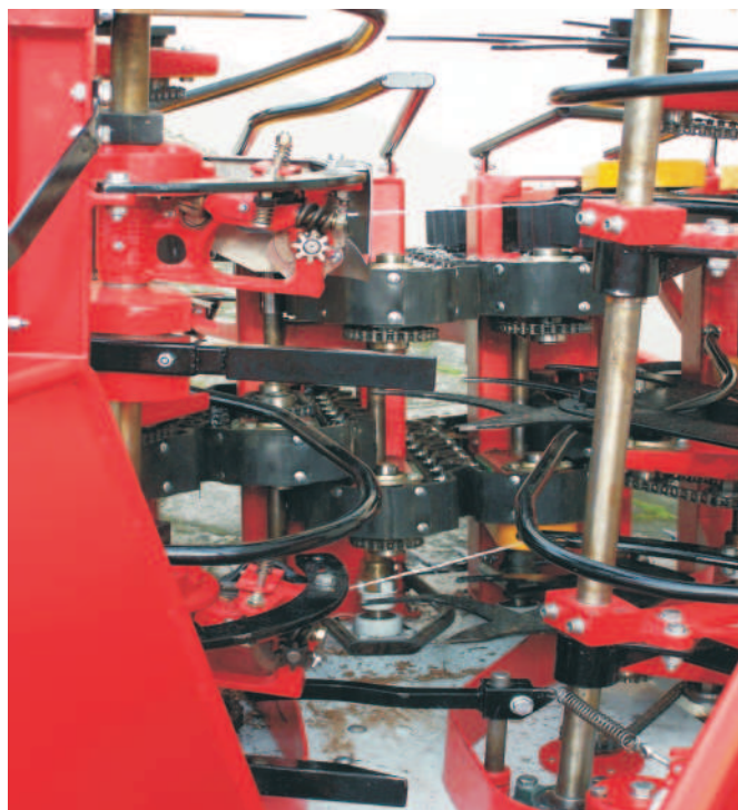
Rys. 3. Aparaty wiążące i rogatka oporowa maszyny do koszenia i automatycznego wiązkania wikliny plecionkarskiej Fig. 3. Binding devices and the resisting toll-bar of the sheaf-binder harvesting machine for wicker
