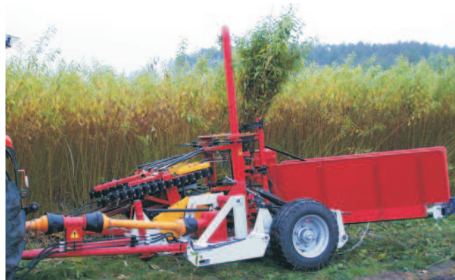
Rys. 1. Maszyna do koszenia i automatycznego wiązkania wikliny plecionkarskiej
