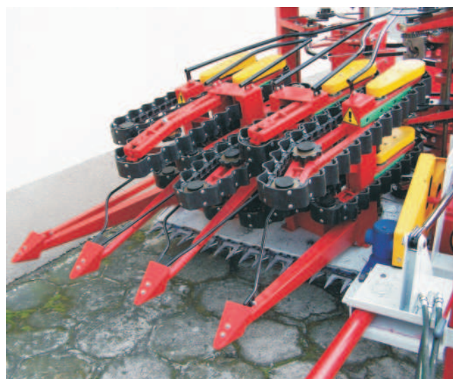
Rys. 2. Zespół tnący i podający maszyny do koszenia i automatycznego wiązkania wikliny plecionkarskiej
