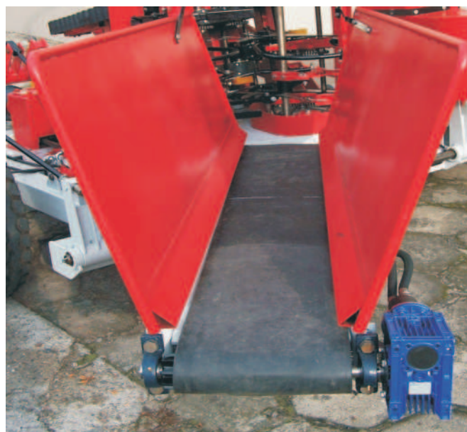
Rys. 4. Przeñośnik transportujący z silnikiem i przekładnią napędową maszyny do koszenia i automatycznego wiązkania wikliny plecionkarskiej Fig. 4. Transporting band conveyor with the hydraulic engine and worm gear of the sheaf-binder harvesting machine for wicker
