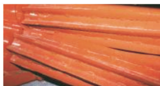
Rys. 2. Walce zgniatające stanowiące wyprofilowane kształtowniki: a - firmy Westward, b, c - firmy Hesston
