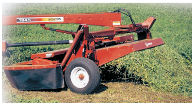
Rys. 1. Kosiarka przyczepiana z rotacyjnym zespołem tnącym i zgniataczem firmy Hesston
