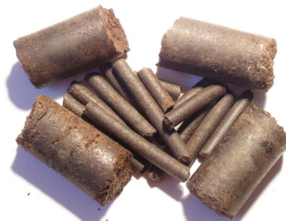
Fig. 9. Briquettes and granules obtained using a granulating and briquetting matrix Rys. 9. Brykiety i granulaty otrzymane z użyciem matrycy granulująco-brykietującej
