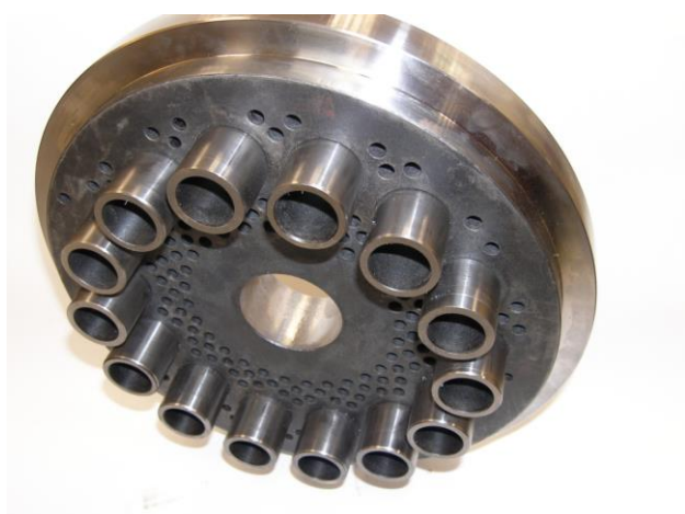
Fig. 8. Briquetting and granulating matrix [14] Rys. 8. Matryca brykietująco-granulująca [14]
