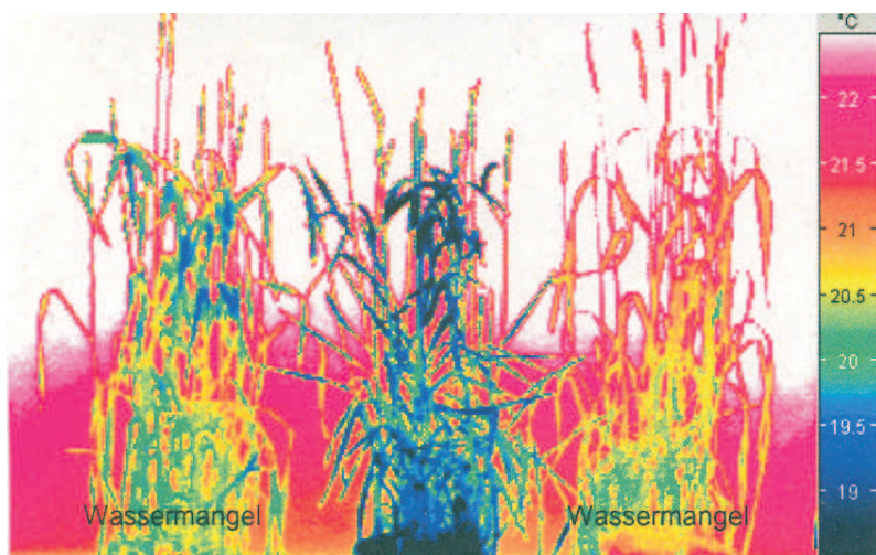
Rys. 1. Fragment pola pszenicy uchwycony metodą pomiaru temperatur przez termokamerę z bliskiej odległości
