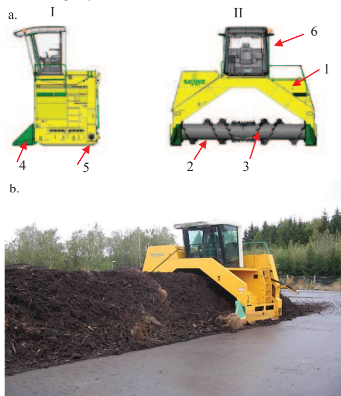
Rys. 1. Maszyna do przerobu pryzm trójkątnych firmy Backhus model 16.43: a - schemat, b - zdjęcie w czasie pracy, I - widok z boku, II - widok z przodu, 1 - tunel, 2 - wirnik, 3 - elementy boczne, 4 - zgarniacz, 5 - podwozie gąsienicowe, 6 - kabina [2]
