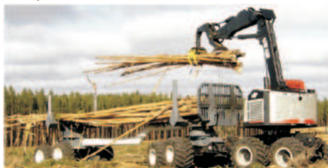
Rys. 2. TimberPro Tf840 - zrywka dłużyc eukaliptusa Fig. 2. TimberPro Tf840 - eucalyptus long-load's forward
