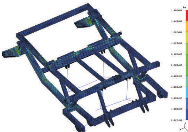
Rys. 16. Naprężenia zredukowane [Pa], sadzarka trzyrzędowa, przypadek LC1
