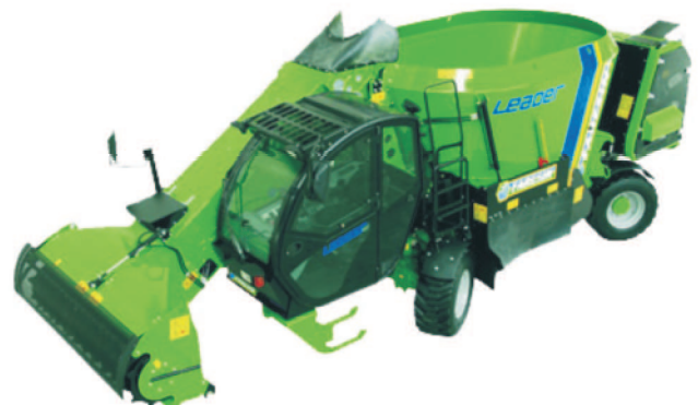
Rys. 3. Samojezdny wóz paszowy Leader firmy Faresin z urządzeniem samozaładowniczym i skrętnymi osiami Fig. 3. Self-propelled forage carrier of the firm Faresin with self-loading device and steered axles
