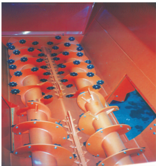
Rys. 3. Mieszadło dwuślimakowe o zwojach współbieżnych do środka z progiem z nożykami jako przeciwstrzami
