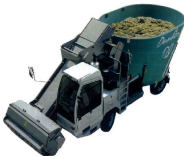
Rys. 5. Samojezdny wóz paszowy Dunker 120 firmy Walker z pionowym jednoślindakowym zespołem mieszającym Fig. 5. Self-propelled feed carrier Dunker 120 of Walker firm with vertical one auger mixing system
