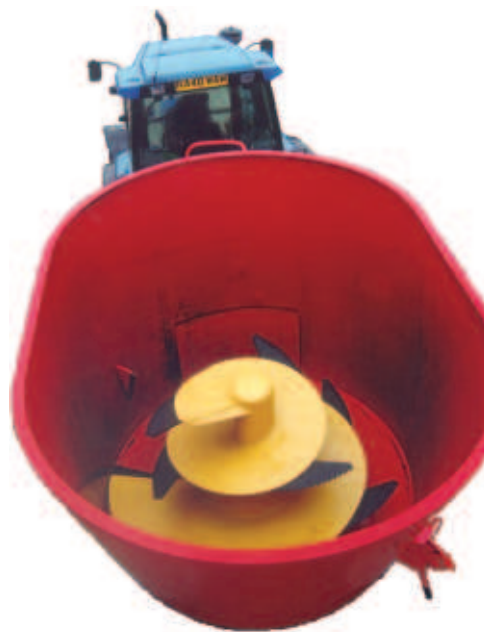
Rys. 1. Wóz paszowy z jednym mieszadłem ślimakowym pionowym
