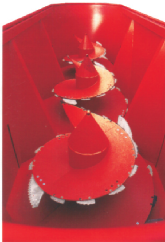
Rys. 4. Zespół trzech pionowych ślimaków zastosowanych w wozie paszowym Biga Mammoet Fig. 4. Three vertical augers mixing system in feed carrier of Biga Mammoet firm
