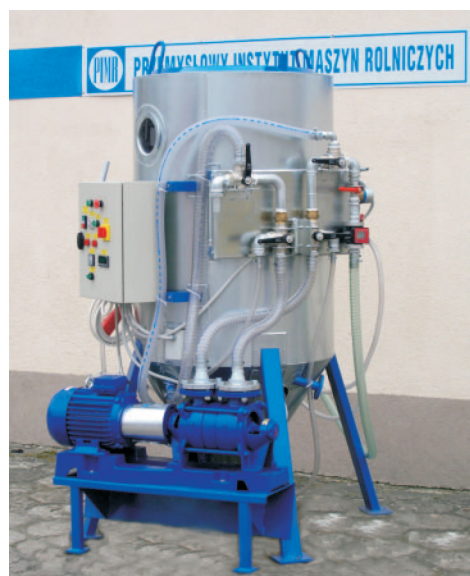
Rys. 3. Wytwórnia nowej generacji do produkcji paliwa odnawialnego z olejów roślinnych do napędu silników z zapłonem samoczynnym wykonana przez firmę PROMAR w Poznaniu Fig. 3. A new generation generator for manufacturing of renewable fuel from vegetable oils for self-ignition engines, manufactured by PROMAR Poznań (Poland)
