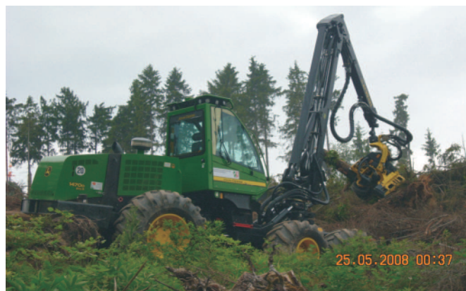
Rys. 1. Harvester John Deere 1470D podczas pracy na powierzchni pohuraganowej (fot. H. Kawalec)
