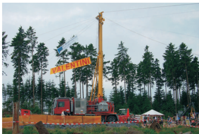
Rys. 2. Kolejka linowa zamontowana na pojeździe samochodowym (fot. H. Kawalec)
