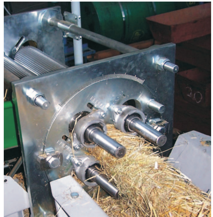
Rys. 2. Płyta przednia (czołowa) stanowiska badawczego z obrotową tarczą umożliwiającą zmianę położenia osi wałków względem osi komory brykietującej Fig. 2. Frontal plate of the test stand with the rotary disc which makes possible to change position of rollers axis with respect to briquetting chamber axis
