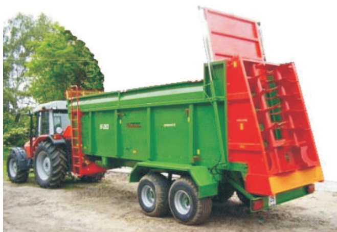
Rys. 3. Rozrzucaacz obornika z adapterem szerokopasmowym dwubębnowym firmy POL-MOT WARFAMA [3] Fig. 3. Manure spreader with two-drum wide-strip adapter produced by POL-MOT WARFAMA [3]
