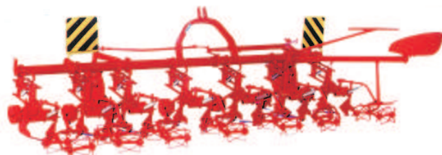
Rys. 5. Pielnik zawieszany 6-rzędowy P 430/2 prod. „Agromet” Jawor Zakład Mechaniczny Sp. z o.o. [www.agromet-jawor.pl]
