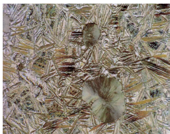
Rys. 4. Widok struktury żeliwa sferoidalnego (ADI) z wytopu 2. Grafit sferoidalny na tle bainitu i austenitu szczątkowego. Pow.300x. [5] Fig. 4. View of the structure ADI cast iron of the sample 2. Spheroidal graphite on the background of bainite and residual austenite. Magnification 300x. [5]
