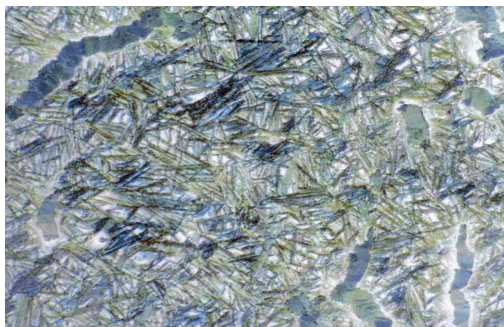
Rys. 6. Widok struktury żeliwa sferoidalnego (ADI) z wytopu 5. Grafit sferoidalny na tle bainitu i austenitu szczątkowego. Pow. 300x. [5]
