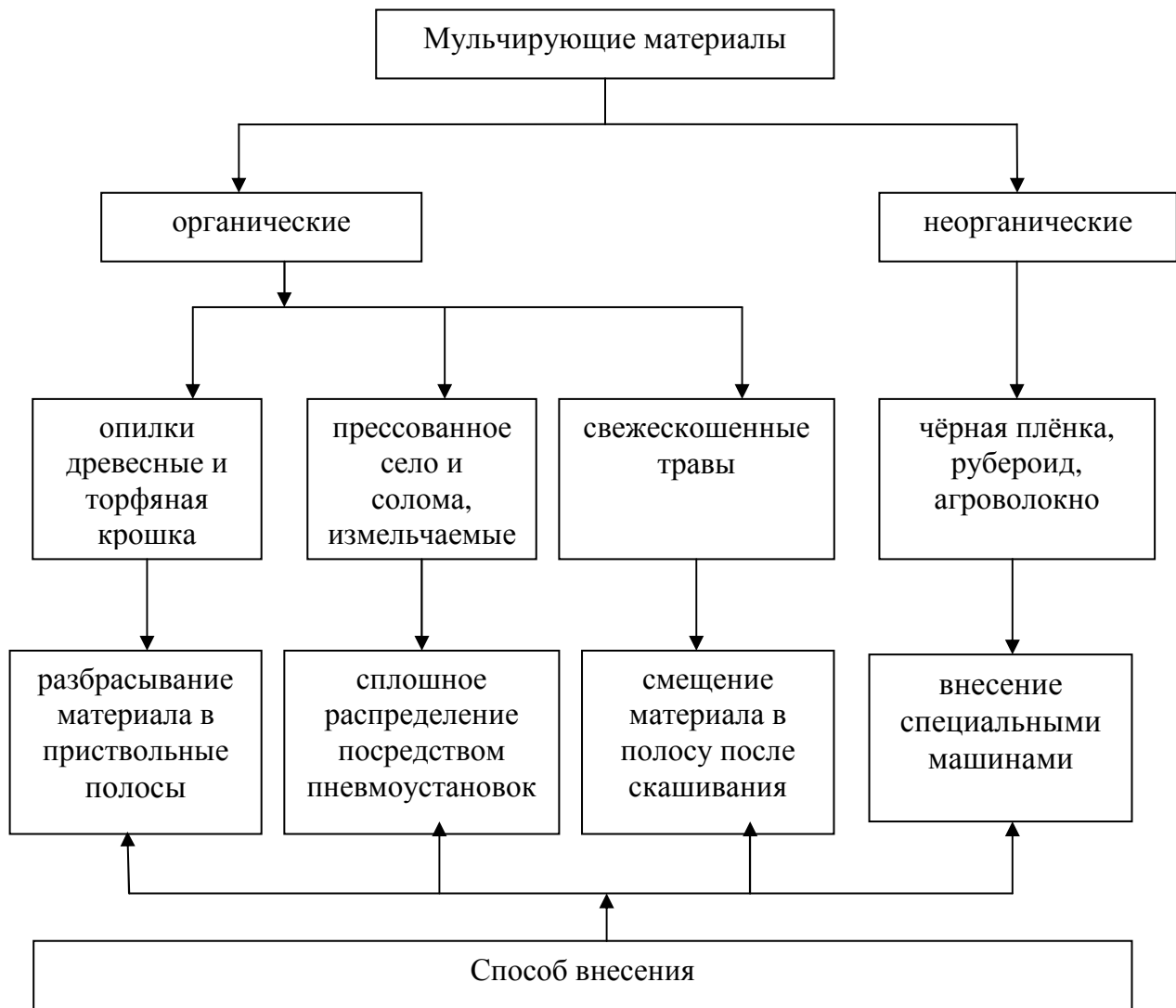
Рис. 1. Классификация мульчирующих материалов и способы их внесения Fig. 1. Classification of mulching substances and method of their storage
