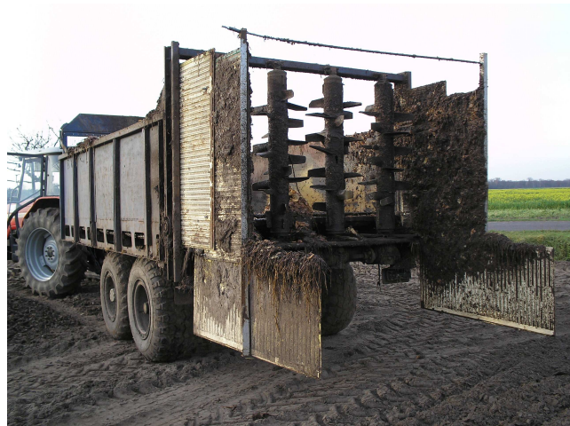
Rys. 2. Rozrzutnik obornika do wstępnego formowania pryzm z kierownicami ograniczającymi szerokość tworzonej pryzmy Fig. 2. Manure spreader for initial windrow forming with the width limiters of composted mass
