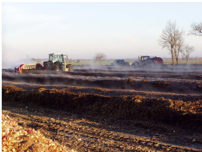
Rys. 3. Napowietrzanie przyzm z zastosowaniem aeratora ciągnikowego Fig. 3. Windrows aeration with usage of tractor aerator
