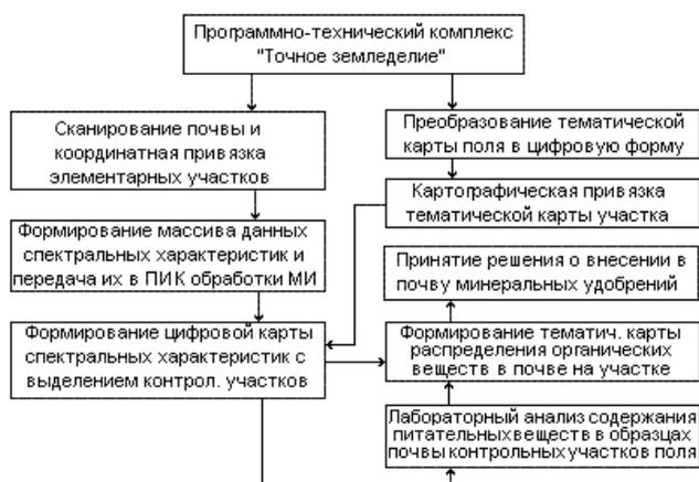
Рис. 1. Функциональная схема программно-технического комплекса «Точное земледелие»
