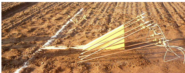
Rys. 5. Usytuowanie czujników pomiarowych w glebie
