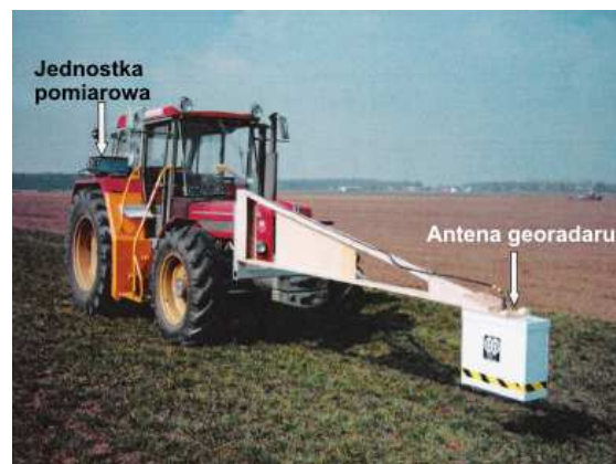
Rys. 1. Umieszczenie anteny radarowej na ciągniku Fig. 1. Placement of radar antenna on the tractor
