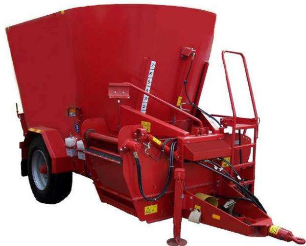
Рисунок 11. Измельчитель-смеситель-раздатчик кормов с вертикальными рабочими органами ИСРВ 12
