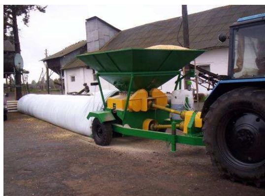
Рисунок 6. Заготовка плющеного зерна с упаковкой в полимерный рукав
