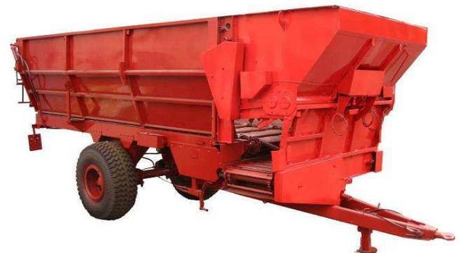
Рисунок 12. Смеситель-раздатчик кормов СРК-10
