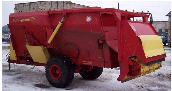
Рисунок 10. Погрузчик-раздатчик-смеситель кормов ПРСК-12
