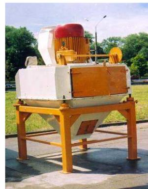
Рисунок 3. Дробилка зерна вертикальная
