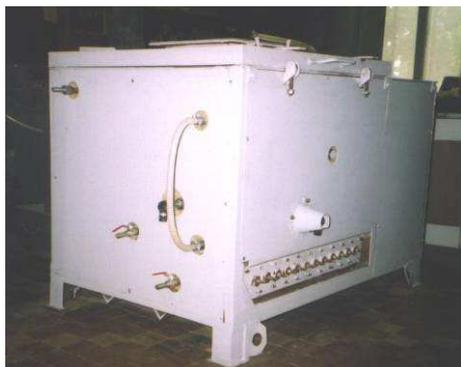
Рисунок 2. Установка для приготовления и ввода жидких добавок и комбикорма
