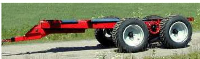
Рис. 1. Активизируемый ходовой модуль полуприцепа
