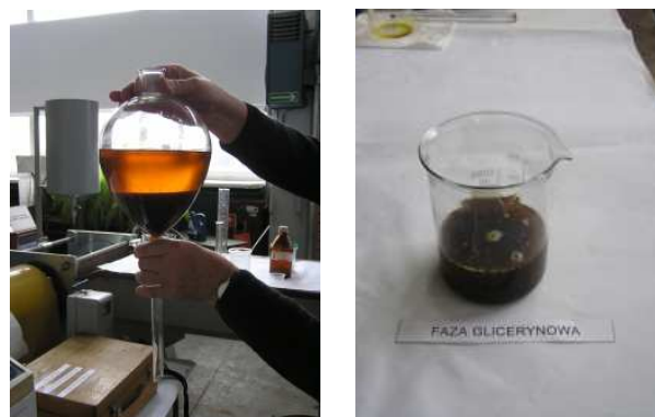
Rys. 4. Rozdziół faz (po lewej) oraz faza glicerynowa (po prawej) Fig. 4. Phase separation (left) and glycerin phase (right)
