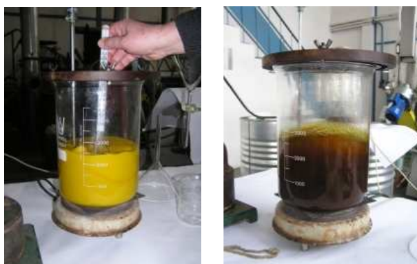
Rys. 3. Roztwór oleju i metanolu przed i po dodaniu katalizatora Fig. 3. A solution of oil and methanol before and after addition of catalyst
