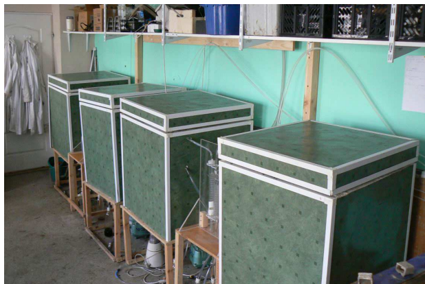
Rys. 2. Bioreaktor do badania procesów rozkładu substancji organicznych Fig. 2. Bioreactor for studying the processes of organic decomposition
