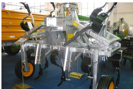
Rys. 9. Aplikator doglebowy TERRAFLEX Fig. 9. TERRAFLEX In-Soil Slurry Applicator
