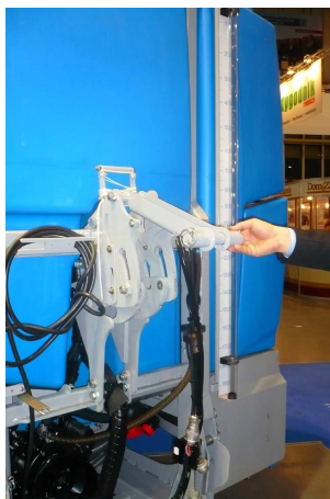
Rys. 12. Automatyczny górny zaczep Quick Connect Fig. 12. Quick Connect Automated Top Hitch
