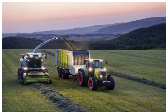
Rys. 3. System Auto Fill firmy CLAAS automatycznego sterowania i kontroli napełniania środków transportowych współpracujących z siewkarnią samojezdzną
