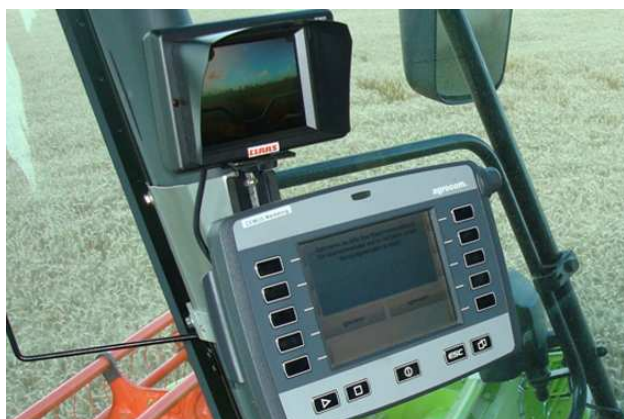
Rys. 2. CEMOS - Elektroniczny System Optymalizacji Maszyn CLAAS
