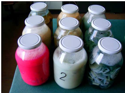
Rys. 1. Przygotowane roztwory wodne chemikaliów wraz z zanurzonymi w nich badanymi próbkami polimerów Fig. 1. Immersion of the samples in the aqueous solutions of the chemicals
