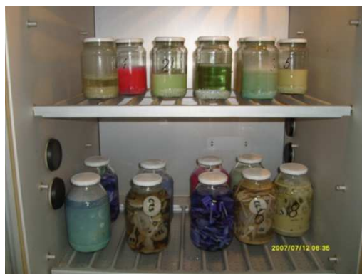
Rys. 2. Ekspozycja próbek z tworzyw sztucznych zanurzonych w roztworach chemicznych, umieszczonych wewnątrz komory klimatyzacyjnej Fig. 2. Immersion of the samples in the chemical solutions put in the air-conditioned chamber
