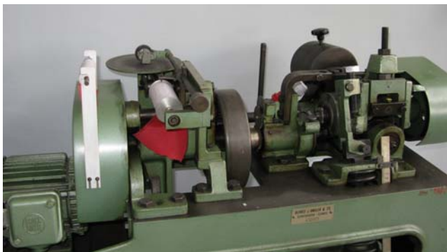
Rys. 3. Widok maszyny Amslera, do badania odporności na ścieranie, przy tarcia metal o metal Fig. 3. View of the Amsler machine used for abrasion resistance test, at metal-metal friction
