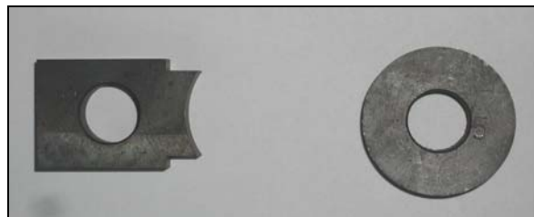
Rys. 1. Widok pary ciernej do badania odporności na ścieranie na maszynie Amslera
