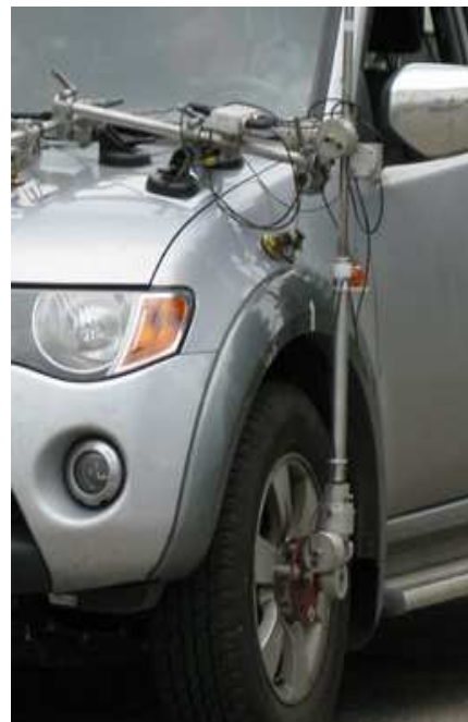
Rys. 7. Układ firmy DATRON do pomiaru położenia koła kierowanego podczas jazdy Fig. 7. Datron's system for measuring steered wheel position
