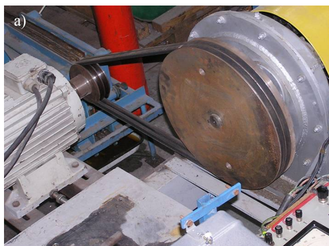
Rys. 3. Koła napędowe zastosowane dla uzyskiwania różnych prędkości obrotowych walców brykietujących: a) 125 i 250 \text{min}^{-1} , b) 375 \text{min}^{-1}
