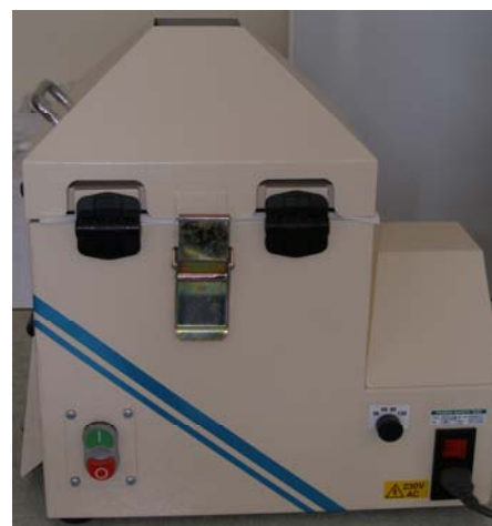
Rys. 2. Stanowisko do pomiaru współczynnika wytrzymałości kinetycznej P_{dk} granulatu metodą Holmena: a) schemat stanowiska, b) widok testera
