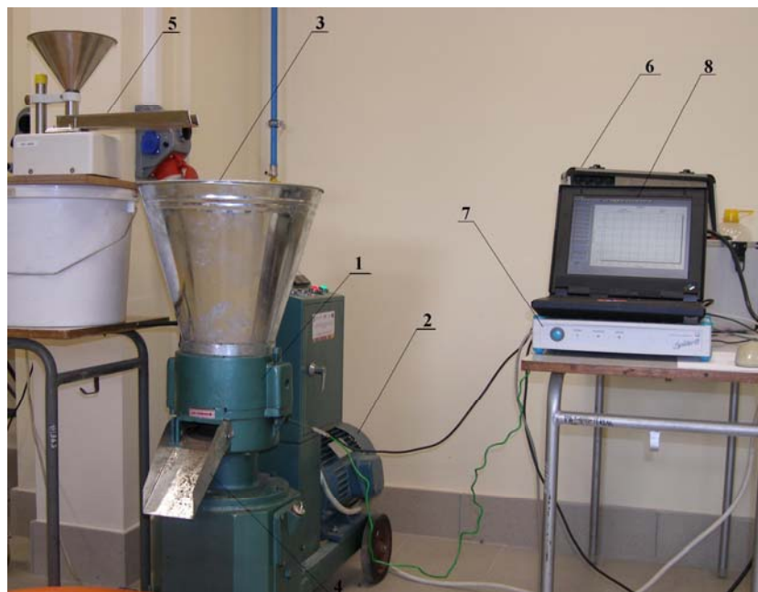
Rys. 1. Stanowisko badawcze SS-4: a) schemat stanowiska: 1- układ roboczy granulatora z matrycą płaską, 2- silnik elektryczny napędzający granulator, 3- zasyp surowca, 4- wysyp granulatu, 5- dozownik wibracyjny, 6- uniwersalny miernik do pomiaru zapotrzebowania na moc, 7- rejestrator Spider, 8- komputer PC, b) widok stanowiska
