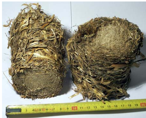
Rys. 1. Brykiety ze słomy pszenicy odmiany Roma Fig. 1. Briquettes from straw from wheat varieties Roma
