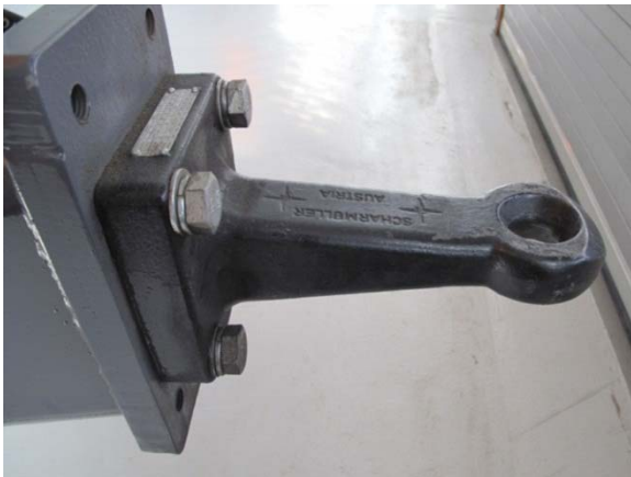
Rys. 2. Zaczep łączący maszynę rolniczą z ciągnikiem Fig. 2. Hitch connects agricultural machine with tractor
