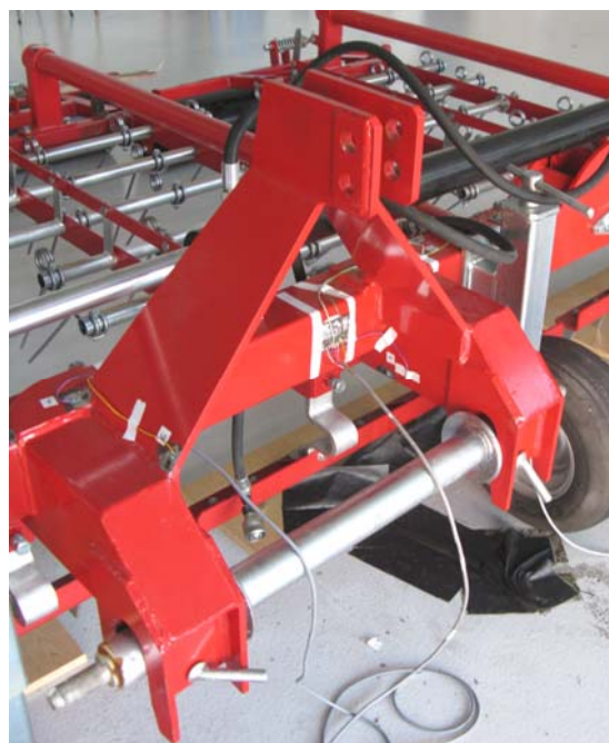
Rys. 1. Połączenie maszyny rolniczej z ciągnikiem przy użyciu trzypunktowego układu zawieszenia Fig. 1. The combination of agricultural machine with tractor using three-point hitch linkage
