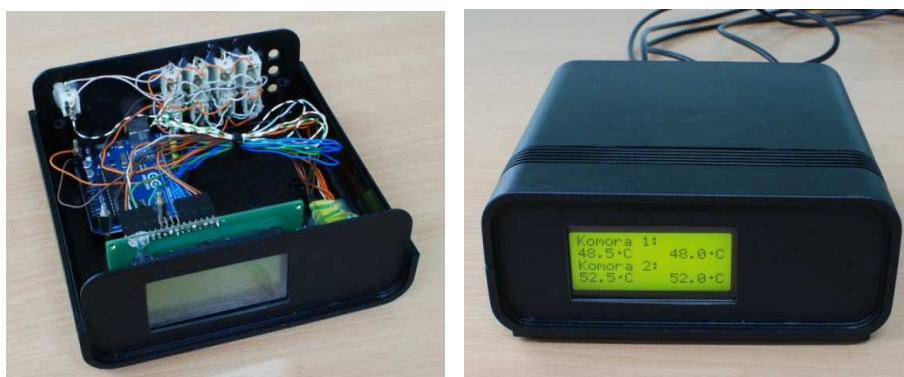
Rys. 4. Jednostka pomiarowa systemu do monitorowania temperatury kompostowanego materiału (źródło: opracowanie własne) Fig. 4. Measurement unit of system for monitoring the temperature of composted material (source: the authors' study)
