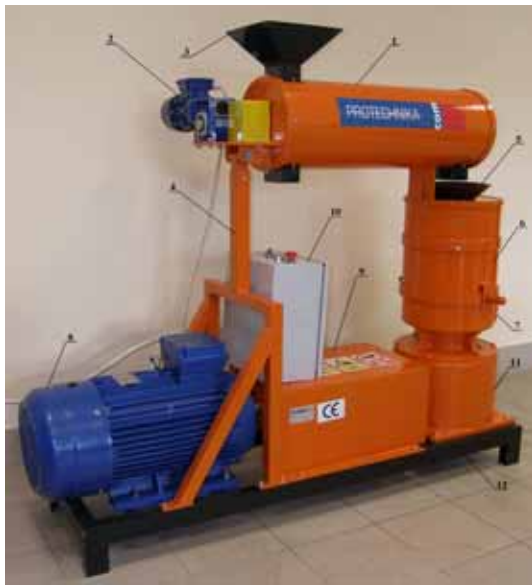
Fig. 3. Prototypowe urządzenie granulująco-brykietujące: 1 - układ mieszająco-granulująco-dozujący, 2 - napęd urządzenia mieszająco-granulująco-dozującego, silnik elektryczny MS7124 z reduktorem PM50, 0,37 kW, 1370 obr/min, 3 - zasyp, 4 - podpora mocująca, 5 - zasyp, 6 - układ roboczy, 7 - wysyp, 8 - silnik elektryczny YX3-180L-4B3IE2, 22 kW, 1470 obr·min -1 , 9 - wbudowany momentomierz Mi20 (PIMR), 10 - szafka sterownicza, 11 - przekładnia zębata przelozenie 1:6,8, 12 - podstawa Rys. 3. Prototypowe urządzenie granulująco-brykietujące: 1 - układ mieszająco-granulująco-dozujący, 2 - napęd urządzenia mieszająco-granulująco-dozującego, silnik elektryczny MS7124 z reduktorem PM50, 0,37 kW, 1370 obr/min, 3 - zasyp, 4 - podpora mocująca, 5 - zasyp, 6 - układ roboczy, 7 - wysyp, 8 - silnik elektryczny YX3-180L-4B3IE2, 22 kW, 1470 obr·min -1 , 9 - wbudowany momentomierz Mi20 (PIMR), 10 - szafka sterownicza, 11 - przekładnia zębata przelozenie 1:6,8, 12 - podstawa
