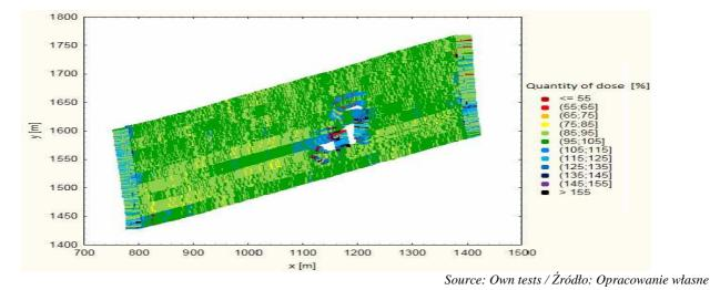
Fig. 6. Areal distribution of the momentary doses of spray made based on the monitoring of the speed of the field sprayer *Rys. 6. Rozkład powierzchniowy chwilowych dawek oprysku wykonany na podstawie monitoringu prędkości jazdy opryskiwacza polowego*
