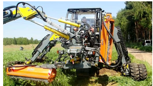
Fig. 6. Setting the device over the watercourse Rys. 6. Ustawienie urządzenia nad ciekiem melioracyjnym
