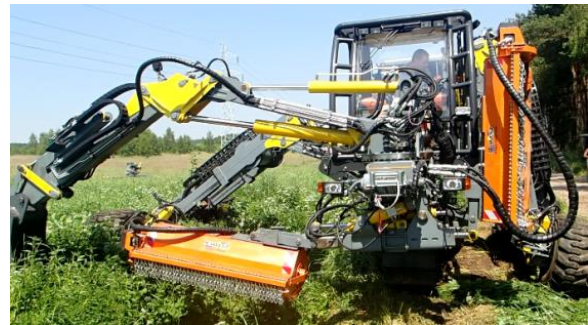
Fig. 5. Insertion of the side arm in the slope Rys. 5. Wstawianie ramienia bocznego na skarpe
