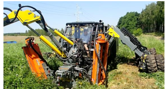
Fig. 7. Lowering the device into watercourse Rys. 7. Opuszczenie urządzenia do cieku melioracyjnego
