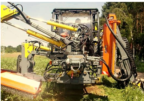
Fig. 11. Insertion of the side arm to the bottom of the watercourse Rys. 11. Wstawienie ramienia bocznego do dna ciekłu
