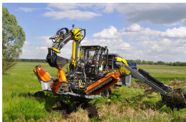
Fig. 13. Entering to small ditches without escarpment grading Rys. 13. Wjeżdżanie do małych rowów bez rozkopywania skarp
