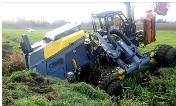
Fig. 14. Leaving small ditches without escarpment grading Rys. 14. Wyjeżdżanie z małych rowów bez rozkopywania skarp
