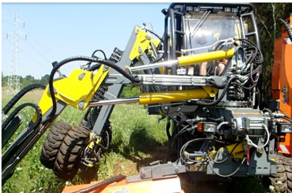
Fig. 3. Insertion of the side arm to the bottom of the ditch Rys. 3. Wstawianie ramienia bocznego do dna rowu
