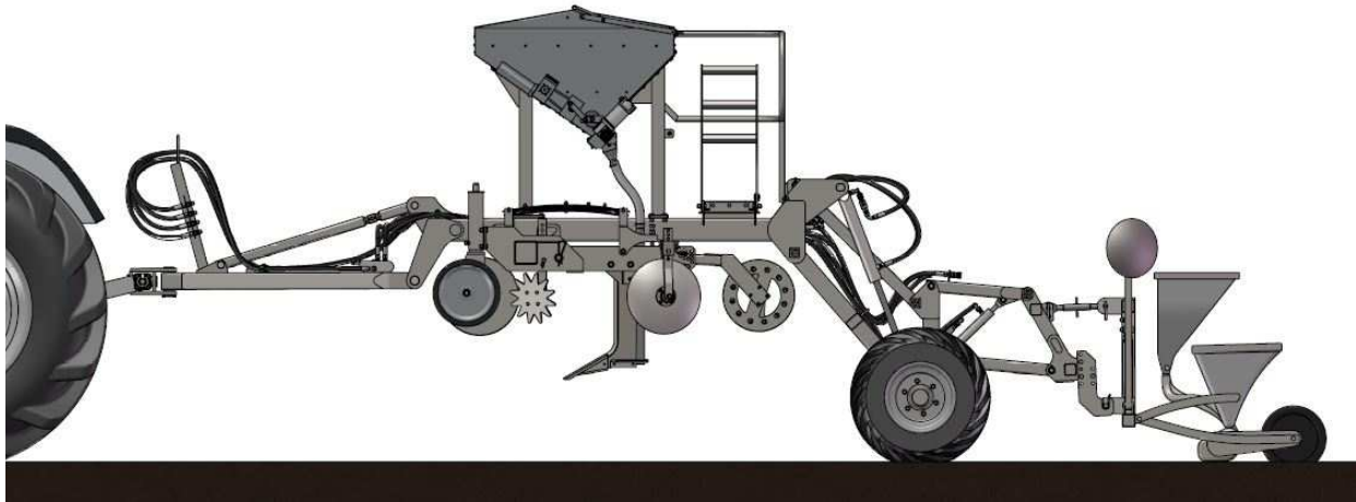
Fig. 5. Unit in the operating position at the start of the corn sowing from the point where strip tillage was started Rys. 5. Agregat w położeniu roboczym podczas rozpoczęcia siewu kukurydzy od początku śladów uprawy pasowej
